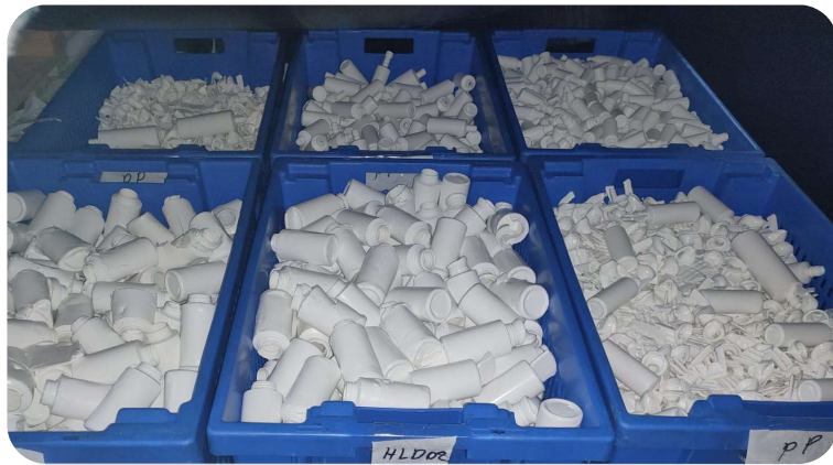
Etapa 4 - Preparación del material recuperado ya lavada para su posterior triturado.
